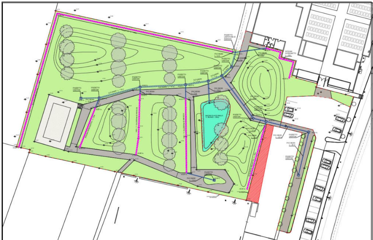
Figura 3 – Estratto planimetria opere di progetto con indicazione della rete fognaria di progetto in blu e delle scoline di progetto in magenta
